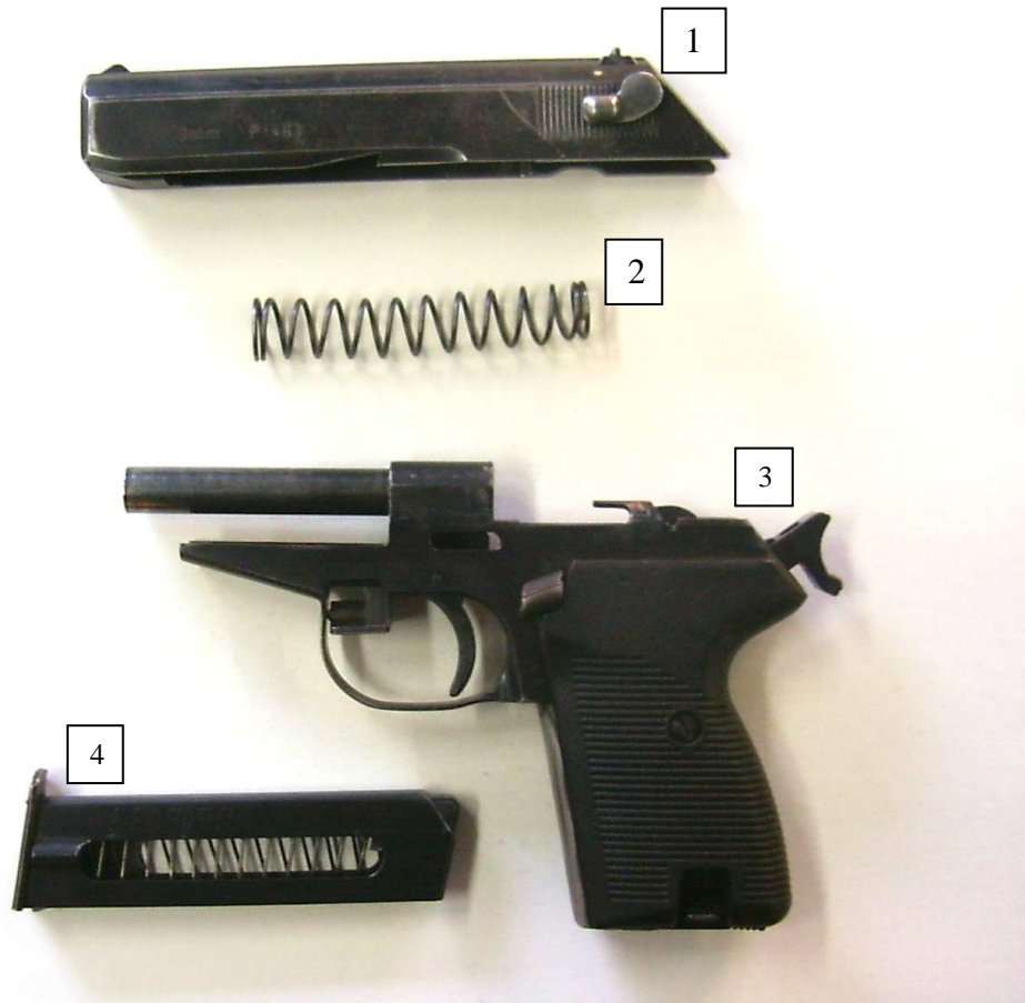
Rys.14. Pistolet P-83 częściowo rozłożony
