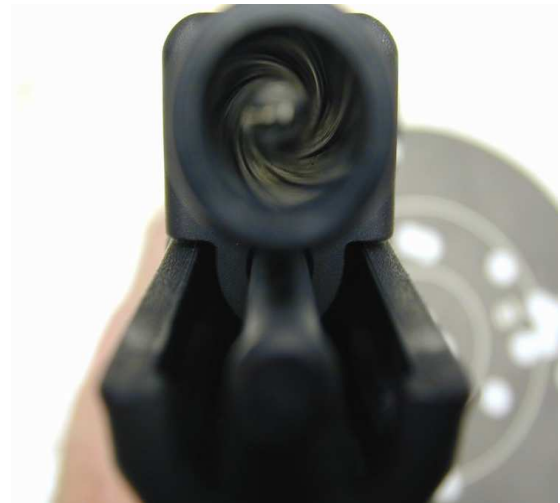
Rys. 20. Lufa poligonalna pistoletu GLOCK
