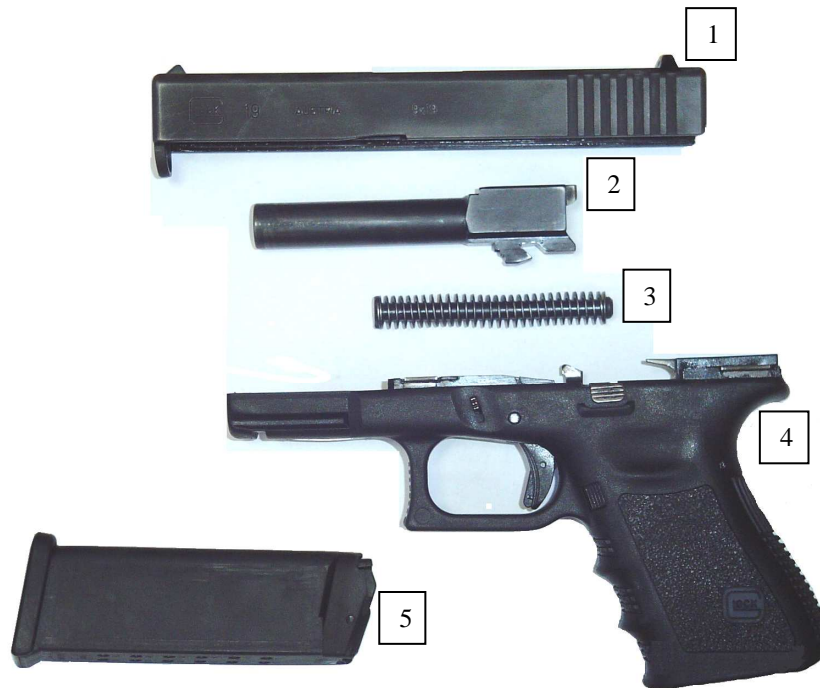
Rys. 19. Pistolet GLOCK częściowo rozłożony
