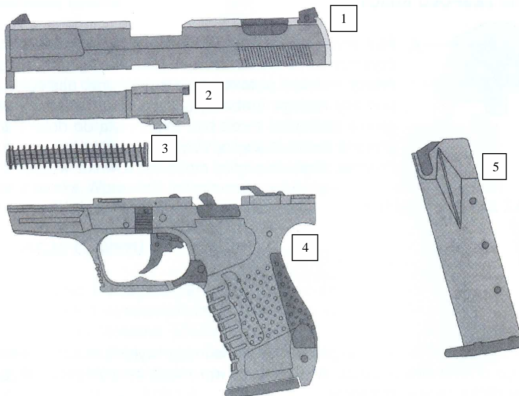
Rys. 28. Pistolet Walther P-99 częściowo rozłożony
