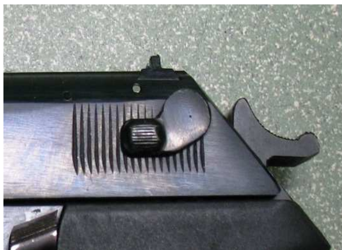
Rys. 15. Bezpiecznik w stanie zabezpieczonym
