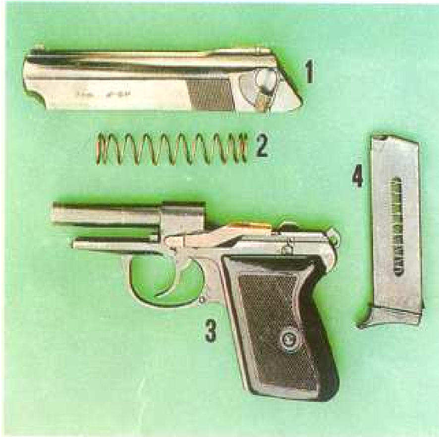
Rys. 7. Pistolet P-64 częściowo rozłożony
