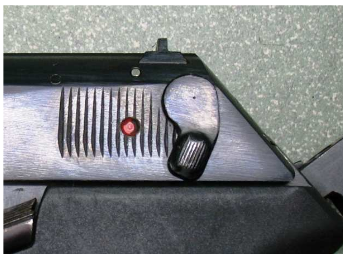
Rys. 16. Bezpiecznik w stanie odbezpieczonym
