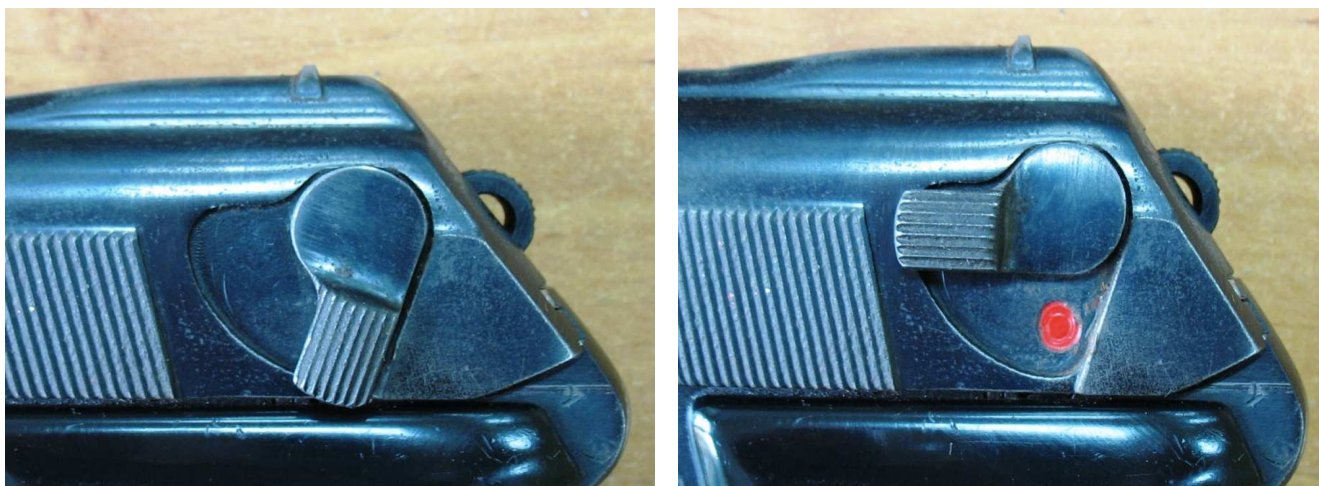
Rys. 11 i 12. Bezpiecznik w stanie zabezpieczonym (lewa strona) i odbezpieczonym (strona prawa)
