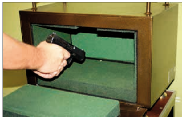
Fot. 67. Wykorzystanie atestowanej skrzynki bezpieczeństwa służącej do bezpiecznego sprawdzenia broni
