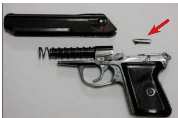
Fot. 17. Pistolet P-64 z uszkodzonym wyrzutnikiem
