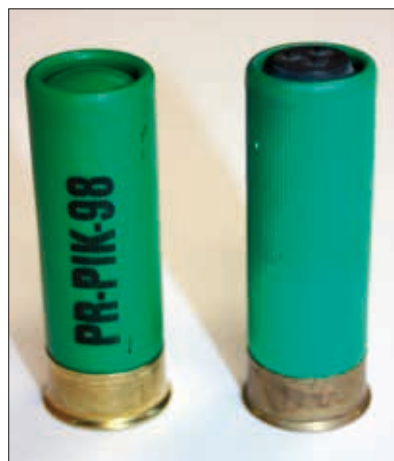
Fot. 24. Nabój karabinowy z widoczną korozją i uszkodzeniami spłonki oraz dna łuski
