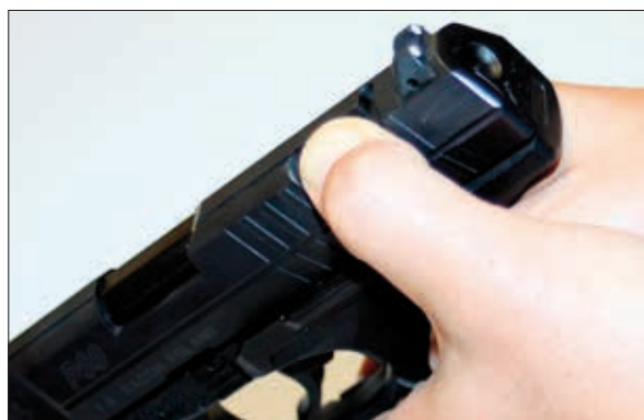
Fot. 6. Zwolnienie napięcia iglicy przy wykorzystaniu przeznaczonej do tego celu dźwigni
