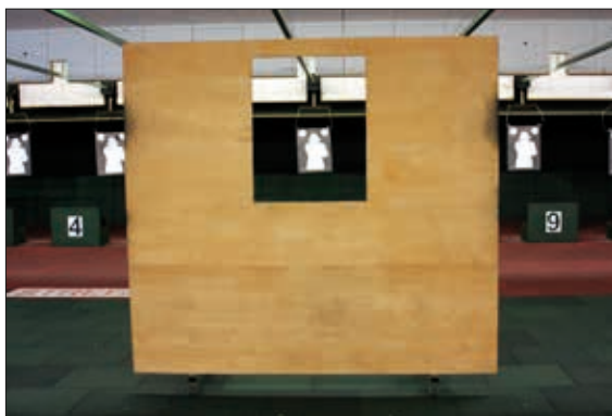
Fot. 70. Przesłona wysoka z otworem okiennym
