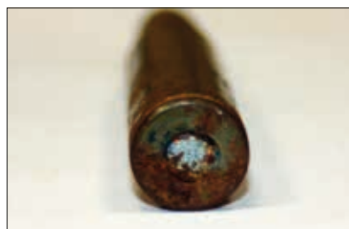
Fot. 24. Nabój karabinowy z widoczną korozją i uszkodzeniami spłonki oraz dna łuski
