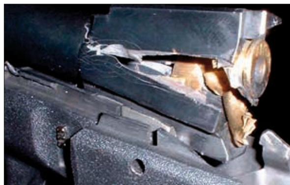
Fot. 21. Rozerwanie komory naboju w wyniku zastosowania amunicji ze zwiększoną naważką prochową
