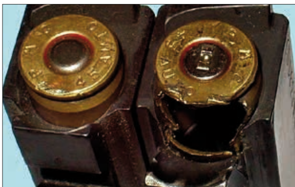
Fot. 20. Pęknięcie brody zamka i rozerwanie naboju w komorze naboju
