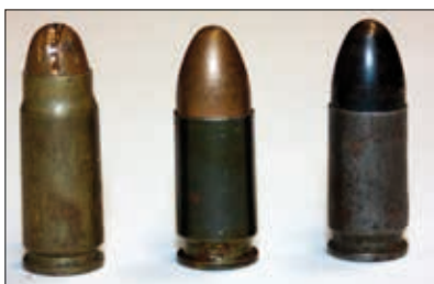
Fot. 23. Amunicja do broni palnej krótkiej w złym stanie technicznym
