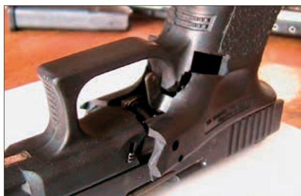
Fot. 19. Rozerwanie szkieletu broni w wyniku ładowania amunicji nieprzeznaczonej do tego typu broni
