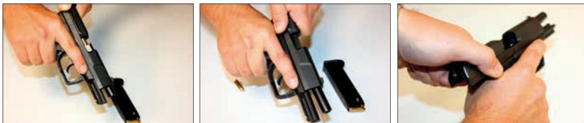
Fot. 4. Sprawdzenie, czy w komorze nabojeowej nie znajduje się amunicja, poprzez kilkukrotne odciążenie zamka w warunkach ograniczonej widoczności lub cofnięcie zamka i kontrolę wzrokową wnętrza komory nabojeowej, jeżeli widoczność jest dobra
